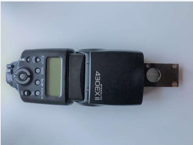
Umbau auf Schieberblitz
