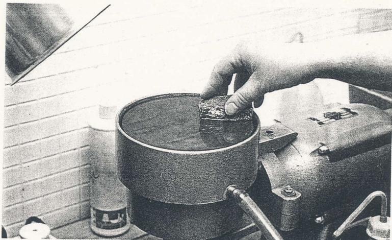
Bild 4: Herstellung eines Erzanschliffs auf der Grauguß-Läppscheibe aus Bild 1.
